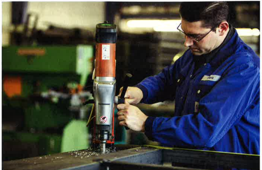
Metallbauer Marte hat als Feldtester die neue Magnet-Kernbohrmaschine KBM 50 U schon vor dem Marktstart ausprobieren können.
